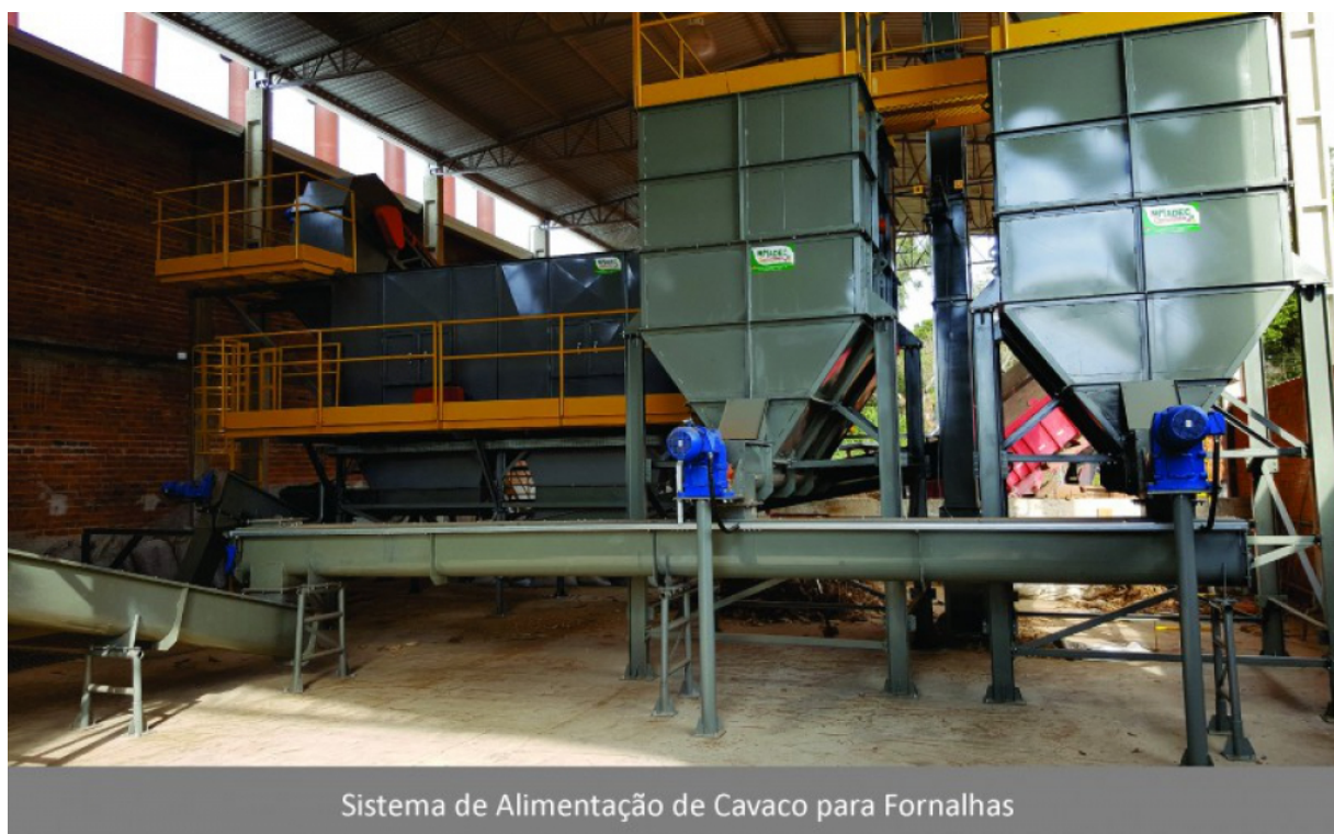
Figura 1 – Sistemas de Alimentação de Cavaco de Eucalipto para fornalhas.
